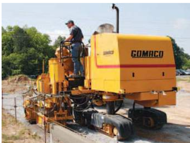
Машина GT-3400 снабжена новым трехгусеничным основанием с двумя близко расположенными гусеничными тележками на одной стороне и одной тележкой на другой стороне. Это основание с управлением всеми тележками обеспечивает возможность поворота по малому радиусу и облегчает регулировку и выход на линию укладки цементобетона.
