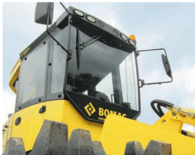
Комфортная кабина с системой защиты при опрокидывании (ROPS) и конструкцией для защиты от падающих предметов (FOPS) в качестве стандартного оборудования
