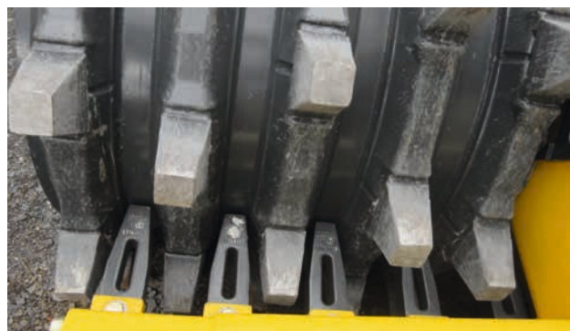
Скретки с возможностью регулирования для бесперебойной эксплуатации.
