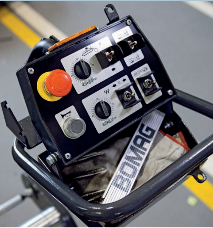
Обратите внимание: вращающаяся платформа оператора с боковыми навесками оснащена вместительной полкой.
