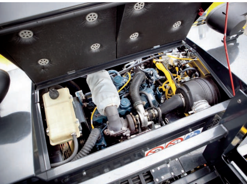
Большая мощность, низкое потребление: двигатель Kubota финишера BF 300.
