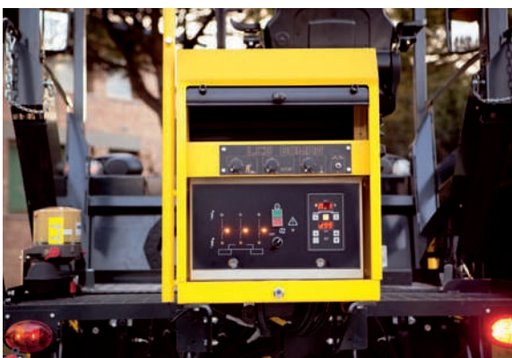
Возможность автоматического отсоединения разравнивающего бруса и настройки температуры.
