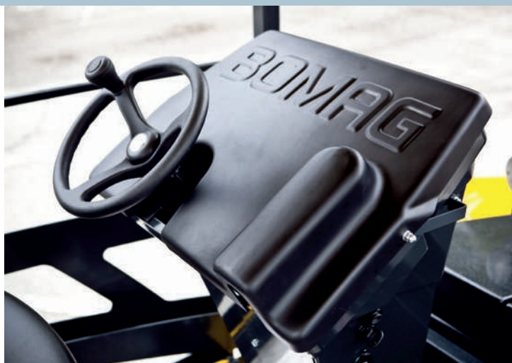
Дополнительная безопасность: обшивка обеспечивает защиту от вандализма и погодных условий.
