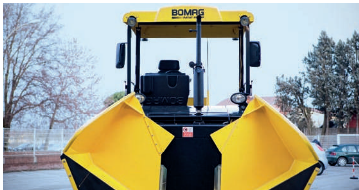
Благодаря системе бокового обзора BOMAG, для работы асфальтоукладчика требуется только одно сиденье и пульт управления.
