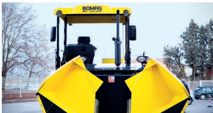
Изменение точки обзора: система бокового обзора BOMAG дает возможность увидеть боковые выступы на 40 см.
